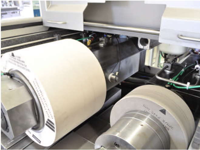
2 Die Schleifspindeln von Heinz Fiege im Einsatz auf der ecoline 400 CNC von Tschudin: Blick von vorne auf die Fiege-Motorspindeln mit Schleifscheibensatz und Regelscheibe (linkes Bild); Blick von hinten auf die eckige Fiege-Motorspindel der Baureihe 910 (rechtes Bild)
