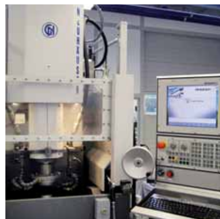
↑ Planschleifmaschine zum Plan- und Hohl Schleifen von scheibenförmigen Zerspanungswerkzeugen
